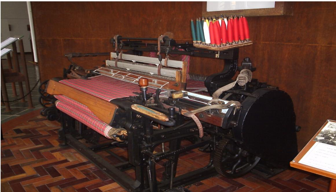
**Figura 5:** tear de lançadeira (revólver), fabricante: Butterworth & Dickinson Ltda, procedência: Inglaterra, ano 1945, 160 RPM/ largura 40"/ tecidos de 0,80 cm de largura. Fonte: Acervo da Indústria Têxtil. Instituto Francisca de Souza Peixoto.
